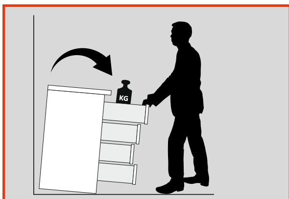
Kippgefahr durch aufstützen
